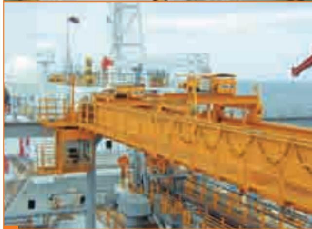
2 Manipulación de rollos de papel \_ Con un total de cinco ejes de movimiento se trasladan de forma rápida y segura los rollos de papel de hasta 18.000 Kg. en StoraEnso.
