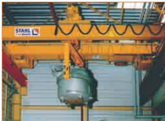
1 Fundición \_ Exigencias fuera de lo normal: funcionamiento permanente, calor, suciedad y cargas de hasta 80.000 Kg. La eficaz tecnología con indicador de cargas conectado de STAHL CraneSystems se ocupa de garantizar la máxima seguridad durante el transporte de los líquidos inflamables.
