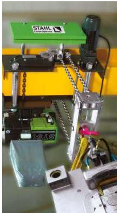
El diseño patentado del carro supercorto reduce la altura en un 60 % y permite alcanzar alturas de elevación extraordinarias.
